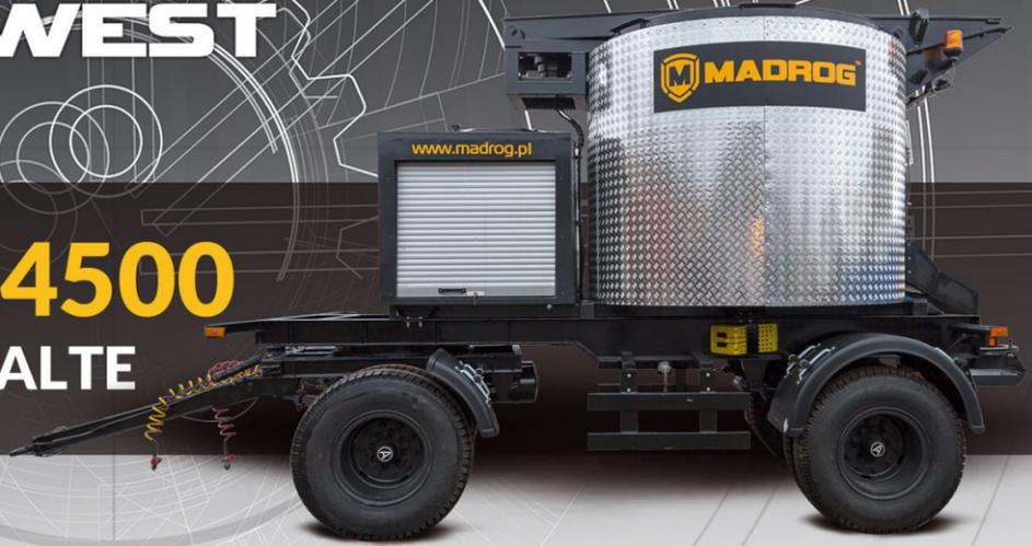
**Notre cuiseur de bitume MADKO 4.5 est une chaudière verticale conçue pour transporter l'asphalte ordinaire, l'asphalte coulé et l'asphalte modifié avec des polymères (PMB). Il peut également être utilisé pour décharger de petites portions de l'asphalte (pour réparer les dommages causés par l'asphalte, par exemple).**
