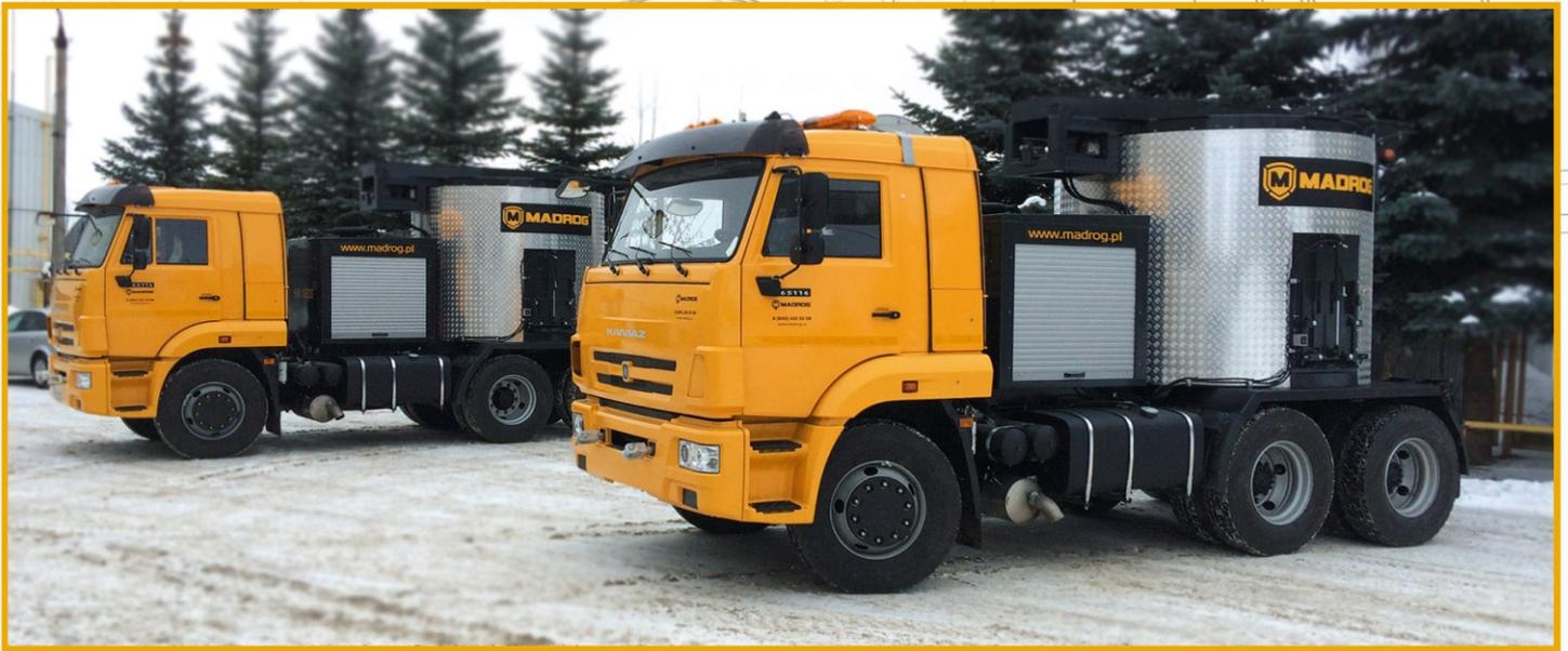
El tanque del digestor está hecho de acero Hardox altamente resistente al desgaste y está equipado con una capa aislante de 50 mm de espesor. Para proteger contra la corrosión, la cubierta exterior de la caldera consiste en una lámina de aluminio.
