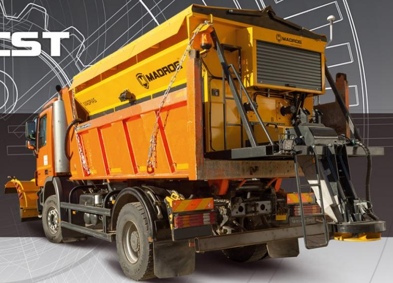
Le MADPIAS est l'épandeur de sable/sel pour l'entretien des routes d'hiver, conçu pour répondre aux conditions de travail sévères de l'hiver russe. Il peut être monté soit sur le châssis du véhicule ou sur le camion benne. À la demande du client, notre MADPIAS peut être équipé d'un système d'humidification au sel pour une élimination efficace de la glace.
