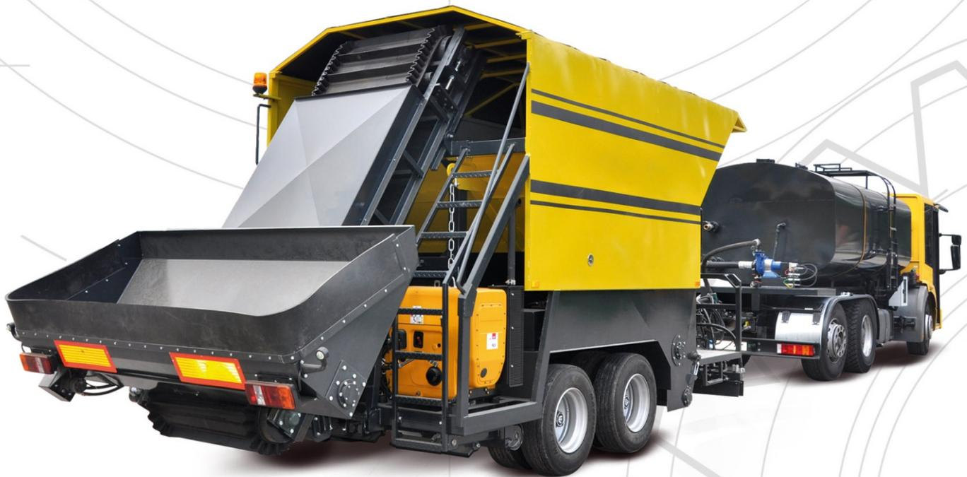
Le système de contrôle par ordinateur permet de conserver l'émulsion et l'agrégat d'asphalte en sortie, exactement en fonction des paramètres définis précédemment, même lorsque la vitesse de la machine ou la largeur de l'application change. Le pupitre de commande est situé à l'avant du KOMBAIN, ce qui aide l'opérateur à contrôler avec précision le processus de rénovation de la route. Toutes les qualités décrites ci-dessus fournissent d'excellents et de très efficaces résultats.
