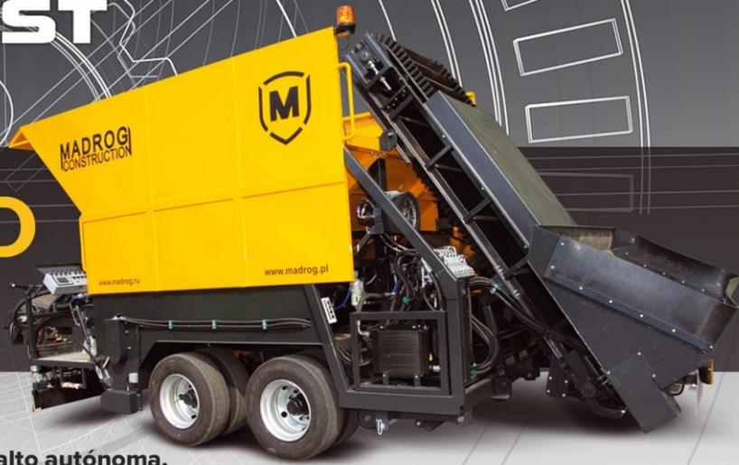
**KOMBAIN KD3D es una máquina de reparación de asfalto autónoma, controlada por computadora, de alta tecnología que funciona con una mezcla de emulsión de asfalto y agregado.**
